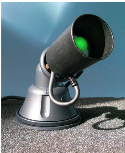
Ryc. 1. Głowica optyczna urządzenia Flicker Fusion. Fig. 1. The optical head of the Flicker Fusion device.
