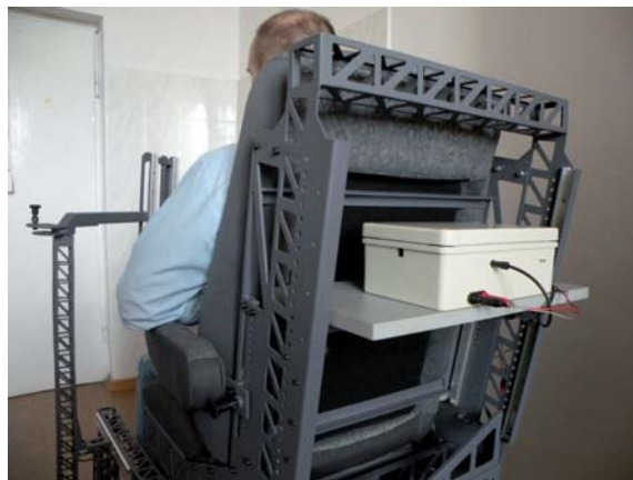
Ryc. 13. Stanowisko pomiarowe-monitorowanie osoby przez oparcie fotela laboratoryjnego. Fig. 13. Fully assembled sensor - monitoring by a laboratory chair.
