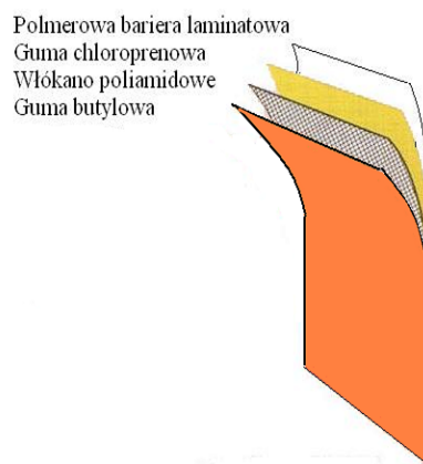
Ryc. 2. Materiał wielowarstwowego chemoodpornego ubrania gazoszczelnego [wg 8].
