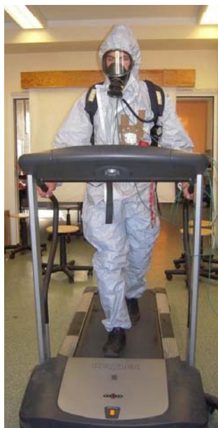
Ryc. 3. Lekkie ubranie ochrony chemicznej U2 (fot. M. Majder-Łopatka).
