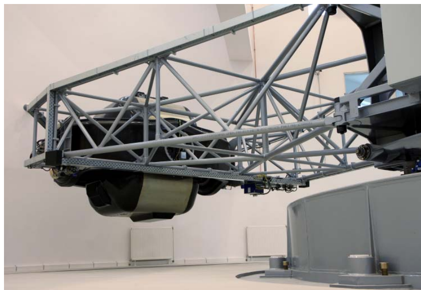
Fig. 2. Gondola and arms of the new polish centrifuge. Ryc. 2. Gondola i ramię wirówki przeciążeniowej.
