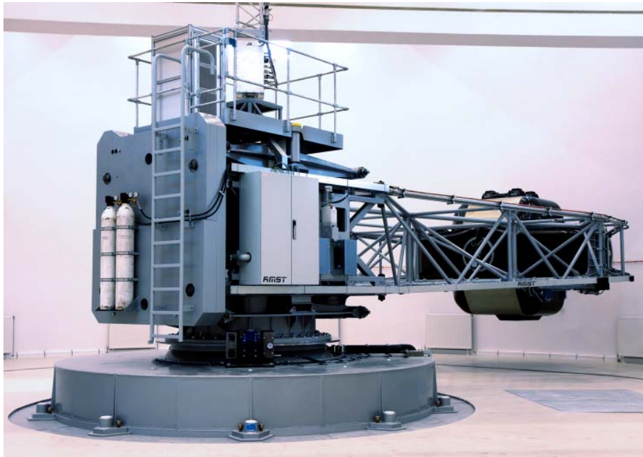
Fig. 1. New human centrifuge at Military Institute of Aviation Medicine in Warsaw, Poland. Ryc. 1. Nowa wirówka przeciążeniowa w Wojskowym Instytucie Medycyny Lotniczej w Warszawie.
